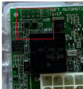
Oxidação / infiltração de líquido - Fora de garantia
